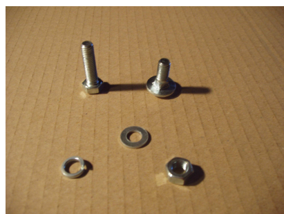
Šroub M8 Šroub vratový M8 Matice Příložka Pérovka
