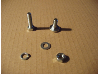
Šroub M8 Šroub vratový M8 Matice Podložka Pérovka
